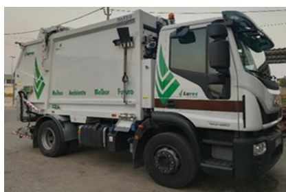
Figura 10 - Viatura Recolha RSU 10/12 m 3 capacidade
