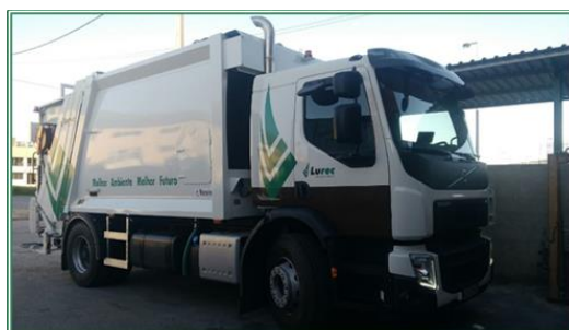
Figura 9 - Viatura Recolha RSU 15 m 3 capacidade
